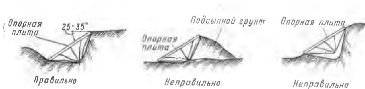
Рисунок 3. Установка опорной плиты миномета
